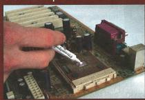
Les processeurs modernes nécessitent l'emploi d'un matériau assurant l'interface entre le processeur et son radiateur, afin de faciliter les transferts de chaleur et d'optimiser le refroidissement. Ce matériau qui aide à
