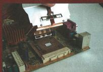
Avant de continuer, vérifiez le sens de fixation du radiateur. La partie qui va couvrir le rebord en plastique du socket (au premier plan sur notre photo) est généralement identifiable sur le radiateur par la présence d'un creux
