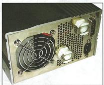
C'est sur la face arrière que viennent se connecter tous les éléments nécessaires à la mise en route, à savoir l'alimentation électrique de la pompe (disponible via un transformateur 220 V fourni), la connexion des tuyaux, et enfin le câble qui relie l'AquaGate à sa carte contrôleur présente dans le bundle.
