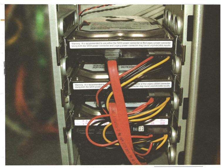
Notre banc test: un IBM 180GXP 60 Go pour le système d'exploitation (Windows XP Pro SP1) et 2 Hitachi/IBM 7K250 80 Go SATA montés en Raid pour les benchmarks.
